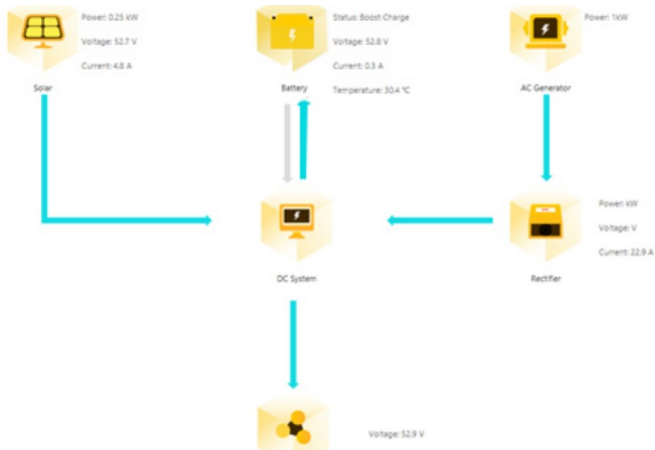
Fig. 2 Schéma de site individuel avec direction du flux d'énergie
